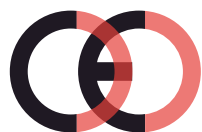
Falsk CE-mærke (for tæt på hinanden)
